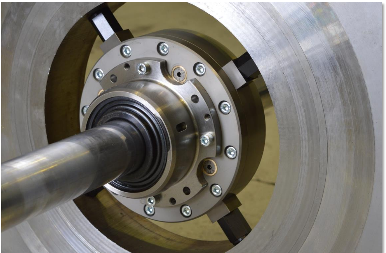
Hier dargestellt: TRAWEMA Innenspannfutter (Frontseite) mit Originallager einer "Climax BB5000" 1 Ausbohrmaschine.
