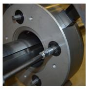
Der Ausrichtvorgang des Spannfutters kann sowohl von Vorder- als auch von Rückseite erfolgen.
