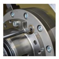
Die Gehäusekomponenten sind aus hochfestem Stahl gefertigt und nitriergehärtet, um Verschleißfestigkeit zu gewährleisten. Gleitflächen sind passgenau durch Schleifen hergestellt, um die erforderliche Präzision und Spielfreiheit zu erzielen.
