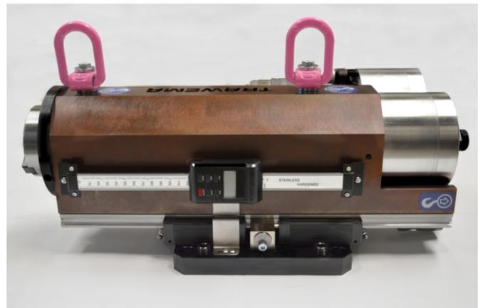
Die Frässpindel kann mit verschiedenen Anbauflanschen sowie Hohlwellen geliefert werden, um Motoren verschiedener Hersteller anzubinden (metrische Anbindung, imperiale „zöllige“ Anbindung). Dies ermöglicht sogar die Anbindung von Druckluftmotoren oder Servomotoren.
